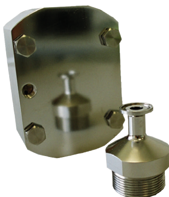
Электрополированная головка насоса и соединения с шероховатостью поверхности Ra 0.4 для более простой очистки
