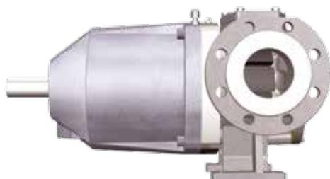
Серия шестеренных насосов Top Gear MAG, разработанная специально для перекачивания токсичных и взрывчатых веществ, представлена 5 типоразмерами с номинальным диаметром патрубков от 50 мм до 125 мм, максимальной подачей до 80 м<sup>3</sup>/ч и максимальным рабочим давлением до 16 бар. Максимально допустимые температура, динамическая вязкость перекачиваемой жидкости и размер твердых частиц в ней для насосов серии Top Gear MAG составляют соответственно 250 °С, 10000 мПас и 0,15 мм.
