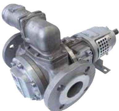
Серия шестеренных насосов Top Gear H, разработанная специально для особо ответственных применений, представлена 9 типоразмерами с номинальным диаметром патрубков от 32 мм до 150 мм, максимальной подачей до 130 м<sup>3</sup>/ч и максимальным рабочим давлением до 16 бар. Максимально допустимые температура, динамическая вязкость перекачиваемой жидкости и размер твердых частиц в ней для насосов серии Top Gear H составляют соответственно 300 °С, 80000 мПас и 0,225 мм.
