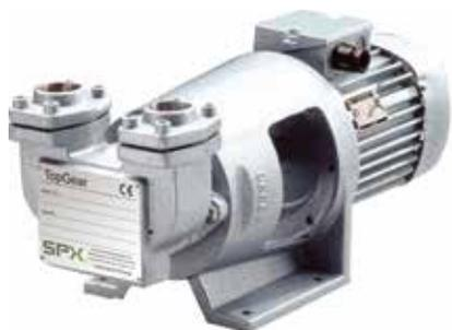
Серия шестеренных насосов Top Gear L & RBS, разработанная для эффективного перекачивания маловязких жидкостей, представлена 7 типоразмерами с номинальным диаметром патрубков от 30 мм до 44,5 мм, максимальной подачей до 84 л/мин и максимальным рабочим давлением до 25 бар. Максимально допустимые температура, динамическая вязкость перекачиваемой жидкости и размер твердых частиц в ней для насосов серии Top Gear L & RBS составляют соответственно 250 °С, 60000 мПас и 0,1 мм.
