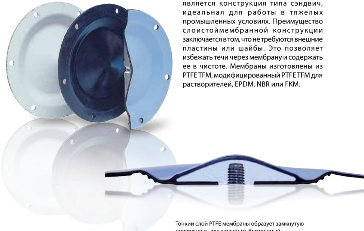
Тонкий слой PTFE мембраны образует замкнутую поверхность для жидкости. Встроенный вспомогательный сердечник из легкого металла и армированная ткань соответствуют высоким требованиям прочности.
