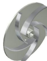
Усиленная крыльчатка - отличный вариант для перекачивания высоко-вязких жидкостей или жидкостей, содержащих твердые частицы. Эта конструкция более жесткая и может выдерживать более высокие напряжения, передаваемые от жидкости.
