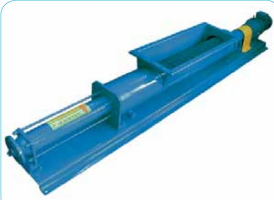
Вспомогательный шнек особой S-образной формы в приемном бункере насосов серии HS делает насос способным перекачивать вязкие жидкости и жидкости с большим содержанием сухого вещества (до 40%). Основное применение насосов серии HS - работа в индустрии очистки и переработки сточных вод, подача стоков на конвейер, работа по перекачке после фильтр-пресса.
