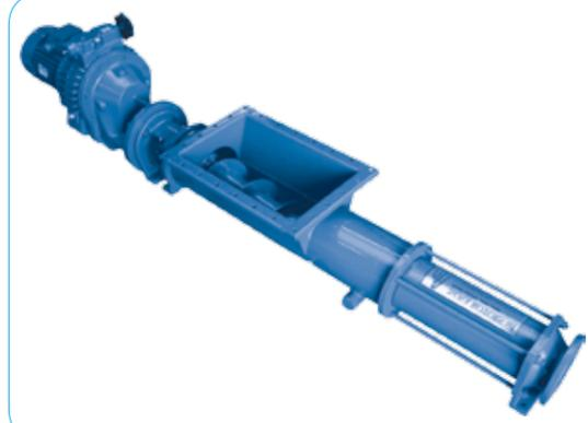
Вспомогательный шнек в приемном бункере насосов серии H делает насос способным перекачивать вязкие жидкости и жидкости с большим содержанием сухого вещества (до 18%). Основное применение насосов серии H - переработка сточных вод, подача стоков на конвейер, работа на фильтр-прессах, перекачка осадков, нефтяного шлама и активного ила. Возможные варианты исполнения насоса из стали или нержавеющей стали.
