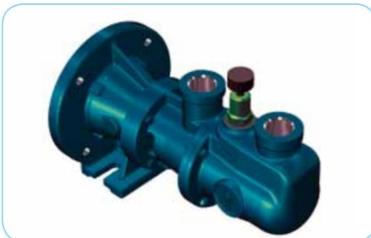
Насосы серии R с плавающим статором имеют следующие преимущества: насос занимает мало места и не требует больших затрат в обслуживании. Статор закреплен только с одного края так, чтобы позволить эксцентричное движение ротора посредством очень простого сочленения. Насос предназначен для использования в пищевой и косметической промышленности.
