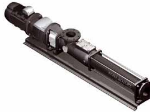
Серия Diamond является реверсивной и доступна в широком диапазоне размерного ряда. Улучшенная геометрия винта с увеличенным шагом, способствовала повышению производительности. В стандартной комплектации винтовые насосы серии Diamond способны создавать давление до 12 бар, как в прямом, так и в обратном направлении.
