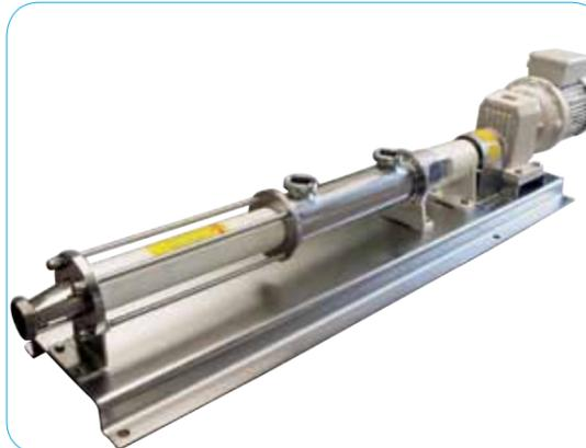
Основное применение насосов серии X - в пищевой промышленности. Специальная конструкция без мертвых зон в рабочей части позволяет уберечь перекачиваемый продукт от порчи бактериями и попадания смазочных веществ, а также легко промывать насос после работы. Насос может оснащаться дополнительными присоединениями для CIP мойки и подпирающим шнеком для перекачки вязких продуктов.
