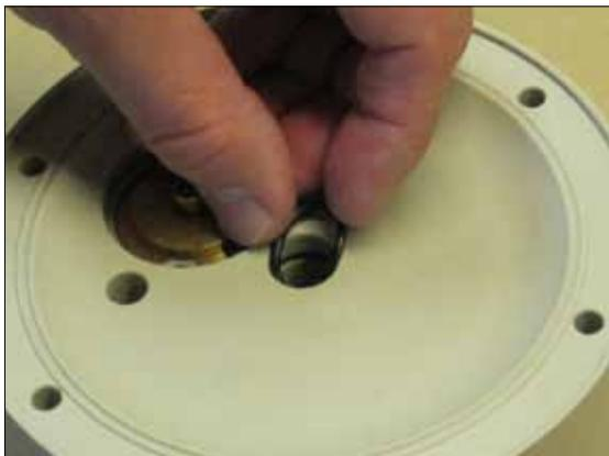
**Рис. 8.6.** Вставьте уплотнительные кольца вала (47) в отверстие.
