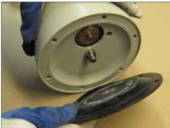
**Рис. 7.4.** Поставьте мембраны (15) в их нейтральное положение (обе мембраны находятся на одинаковом расстоянии от центрального блока). Удерживая одну из мембран (15), открутите другую. Затем снимите оставшуюся мембрану (15) с мембранного вала (16).
