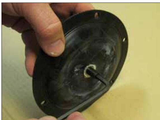
**Рис. 6.4.** Установите контактный винт (часть вала мембраны) (поз 16) надежно в мембрану (15) с помощью шестигранного ключа.
