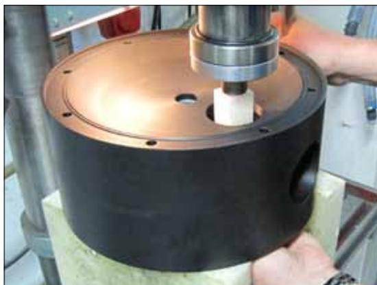
**Рис. 7.11.** Осторожно отожмите цилиндр, не повредив его края.
