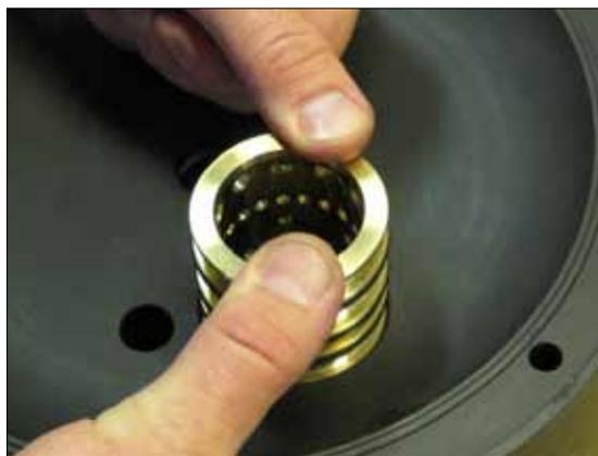
**Рис. 8.6.** Убедитесь, что все четыре уплотнительных кольца (поз 30) установлены на цилиндре. Используйте немного воды на уплотнительных кольцах для лучшего скольжения цилиндра в центроблоке. Другие смазочные вещества не должны использоваться.
