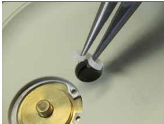
**Рис. 8.7.** Для установки уплотнения вала (36), согните его в почкообразную форму и осторожно вставьте в паз.
