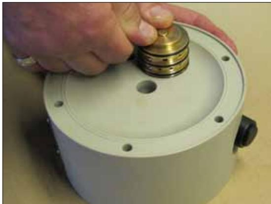
**Рис. 8.2.** Капните немного воды на уплотнительные кольца (30), прочие смазочные материалы не должны использоваться. Аккуратно задвиньте воздушный клапан (61) в корпус. Установите стопорное кольцо (27) на вторую сторону (см. рис. 8.1).
