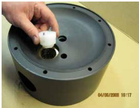
**Рис. 7.10.** Чтобы вытолкнуть цилиндр, используйте другую сторону монтажного инструмента, расположенного в цилиндре.
