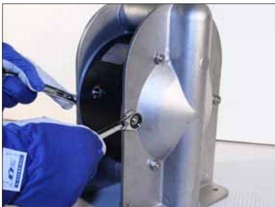
Рис. 7.1. Открутите корпусные гайки (37).
