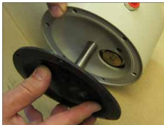
**Рис. 8.9.** Для установки уплотнения вала (36), согните его в почкообразную форму и осторожно вставьте в паз.
