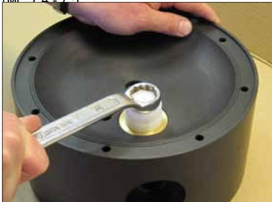
**Рис. 7.8.** Аккуратно открутите край воздушного клапана с помощью монтажного инструмента (282). Проведите ту же операцию с другого края.
