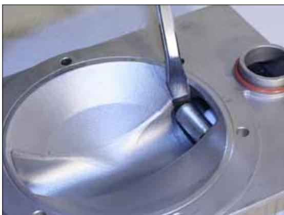
Рис. 7.3. Для того, чтобы извлечь шарики клапана (23), осторожно открутите стопор (22) с помощью отвертки. Пружина может легко выскочить, поэтому берегите глаза.
