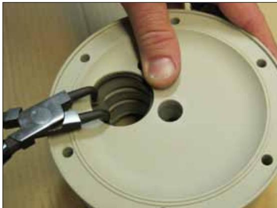
**Рис. 8.1.** Поднимите стопорное кольцо (27) с одной стороны.
