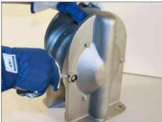
**Рис 5.1.** Открутите винты (37) на одном корпусе насоса (11), положите насос на ту сторону, на которой остались винты на прочное основание и отсоедините корпус.
