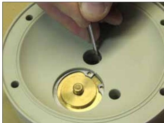
**Рис. 7.5.** Если уплотнения вала (36) изношены (из-за внутренних утечек воздуха), аккуратно удалите их острым инструментом. Во время этой операции возможно повреждение уплотнений (36) и запасного уплотнительного кольца (47), поэтому убедитесь в наличии запасных частей и возможности замены поврежденных уплотнений.
