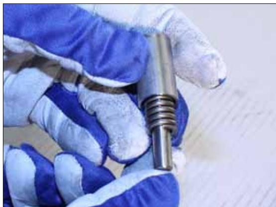
**Рис. 8.10.** Стопорный клапан (22) состоит из штока, пружины и рукава.
