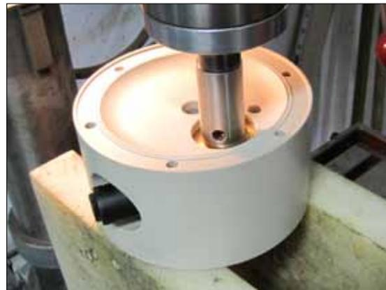
**Рис. 7.7.** Отожмите воздушный клапан (61) с помощью отжимного прибора. Будьте аккуратны, чтобы не повредить медные края воздушного клапана.
