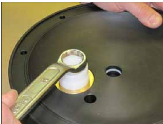
**Рис. 8.4.** Тщательно затяните крышку с помощью монтажного инструмента (поз. 282) и гаечного ключа.
