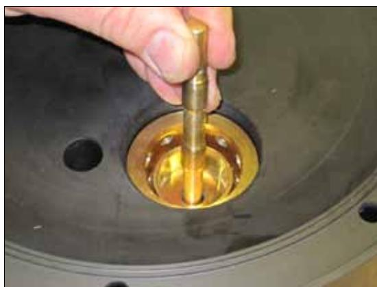
**Рис. 8.8.** Осторожно закрепите поршень и вал вручную. Повторите действия, изображенные на рис. 8.3 и 8.4. Тщательно закрепите заглушки с обеих сторон.
