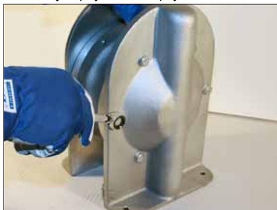
**Рис. 6.9.** Установите центроблок на одном из корпусов (11). Разместите всасывающие/нагнетательные патрубки (13) и уплотнительное кольцо (18) пока корпус лежит на одной стороне. Аккуратно положите на другую половину корпуса (11). Затяните болты (37), рекомендации по моментам затяжки вы найдете в гл.5.5.
