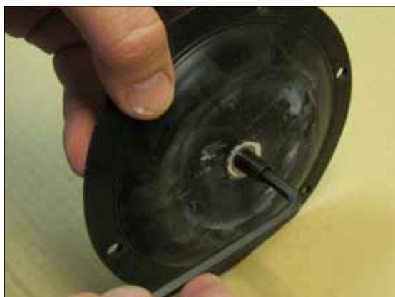
**Рис. 8.8.** Установите контактный винт (часть вала мембраны) (поз 16) надежно в мембрану (15) с помощью шестигранного ключа.
