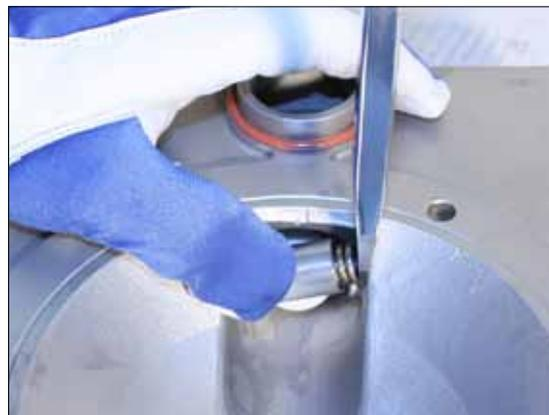
**Рис. 8.11.** Установите шарики клапана на место (вверху и внизу) на обеих половинах корпуса (11).
